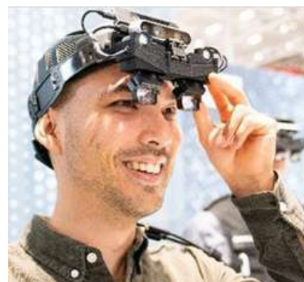
AR-Assistenzsystem, ausgestattet mit stromsparenden 720p OLED-Mikrodisplays
