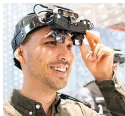
AR-Assistenzsystem, ausgestattet mit stromsparenden 720p OLED-Mikrodisplays
