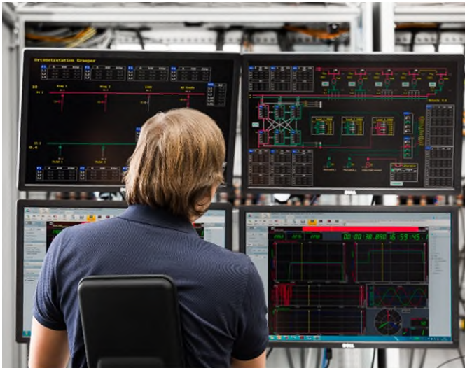
Abb. 1 Die Open-Source-Leitsystem-Plattform InterSCADA wird Verteilungs- und Übertragungsnetzbetreiber in die Lage versetzen, schnell auf plötzliche Systemstörungen zu reagieren.
