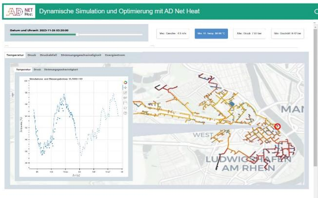
**Abb. 1** Die graphische Benutzeroberfläche zeigt die aktuellen Temperatur- und Druckverhältnisse im Netz. Für jeden Knoten kann der zeitliche Verlauf in der Historie und Prognose dargestellt und gegebenenfalls mit Messungen verglichen werden.
