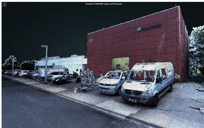
Abb. 2 In der visuellen Darstellung werden die Punktwolken durch Kamerabilder eingefärbt. So entsteht eine virtuelle 3D-Umgebung, die Anschaulichkeit mit exakten geometrischen Informationen verbindet. In der virtuellen Szenerie kann man sich frei bewegen.
