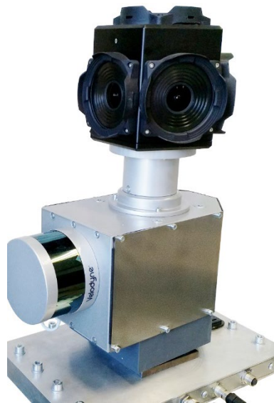
Abb. 1 Der LiDAR-Laser ist auf einem rotierenden Drehteller befestigt. Pro Sekunde tastet der Laser einen Ausschnitt von 16 senkrechten Scheiben ab. Insgesamt sendet das Gerät 1,3 Millionen Laserimpulse pro Sekunde. So entsteht eine 3D-Punktwolke der Umgebung.
