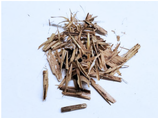
Abb. 1 Im Vergleich zu Holz zeichnet sich Rohrglanzgras durch seinen niedrigeren Ligningehalt aus.
