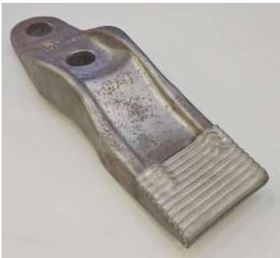
**Abb. 2** Bergbauwerkzeuge wie dieser Zahn einer Baggerschaufel unterliegen einem extremen Verschleiß. Durch das KI-gestützte und hochpräzise Laserauftragschweißen erfolgt die Reparatur schnell und kostengünstig direkt an der Maschine.
