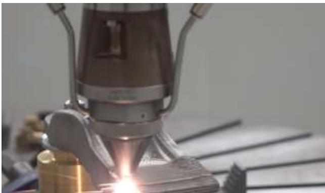
**Abb. 1** Um die Metallschicht in gleichbleibendem Abstand auf die komplexe Oberflächengeometrie der Werkzeuge auftragen zu können, ist der Laserkopf auf drei Achsen beweglich, zusätzlich verfügt er über zwei Rotationsachsen.
