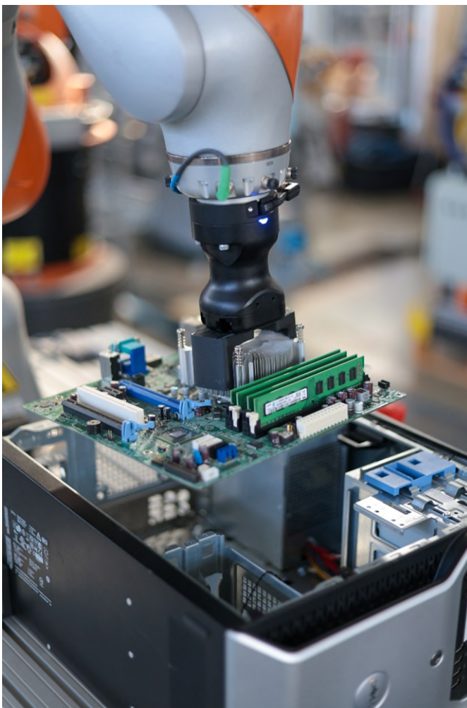
Abb. 1 Der Roboter hebt das Motherboard aus dem Gehäuse.
