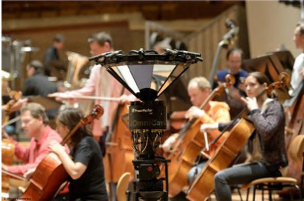
**Abb. 1 Das spiegelbasierte Mehrkamerasystem OmniCam-360 im Einsatz bei den Berliner Philharmonikern.**
