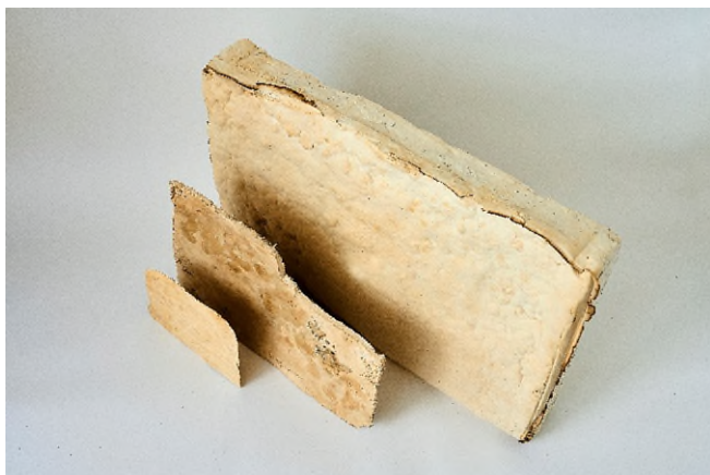
Abb. 2 Flexible Myzelmaterialien in unterschiedlicher Dicke können als Polstermaterial, Dämmplatte oder Lederalternative verwendet werden.
