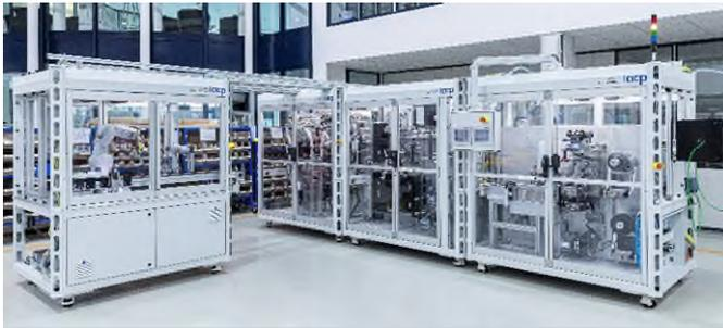
**Abb. 2 Innovative Forschungs- und Entwicklungsplattform: Format- und designflexible Wickelanlage**
