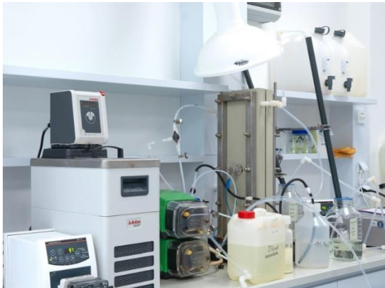
Abb. 2 Saubere Produktion: Der Laborversuchsstand zur umweltfreundlichen Herstellung von grünem Soda durch bipolare Elektrodialyse von Salzsole. Der Prozess vermeidet CO 2 - Emissionen und salzhaltige Abwässer.
