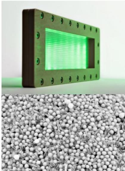
**Abb. 3: Die für die Syntheseschritte benötigten Katalysatoren werden auf transparenten Folien immobilisiert (oben) oder als Katalysator-Partikel eingesetzt (unten). Die Aufnahme des Elektronenmikroskops zeigt einen Ausschnitt aus einem Partikel mit den Trägerpartikeln für Enzyme und Photokatalysatoren. Deren Größe liegt im Nanometerbereich.**
