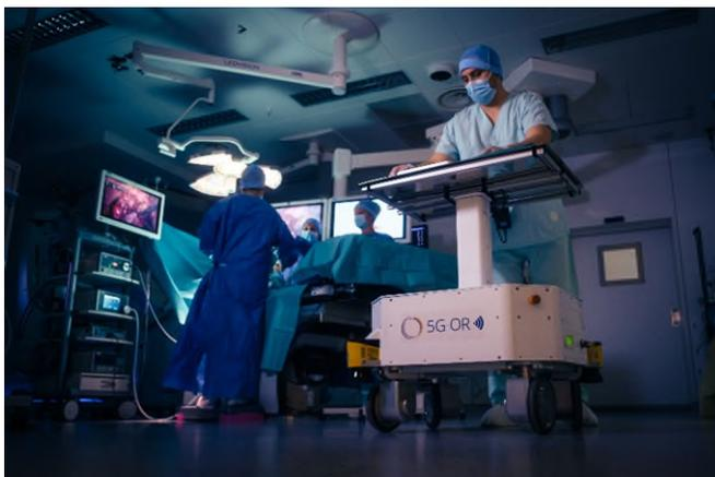
**Abb. 1 Die von der Hochschule Reutlingen gemeinsam mit dem Fraunhofer IPA entwickelte mobile robotische Plattform im experimentellen OP in Straßburg ermöglicht den autonomen Transport von medizinischem Material und Instrumenten.**
