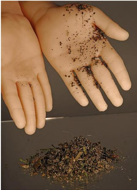
Abb. 2 Die vakuumultraviolette Modifizierung von Silikonoberflächen ist ein möglicher Ersatz zur Gasphasen-Fluorierung. Die schmutzabweisende und verschleißresistente Funktionsschicht erlaubt vielfältige Anwendungen in der Medizintechnik von haptisch angepassten Prothesen bis hin zu schmutzabweisenden Beatmungsmasken. Die behandelte Silikonhand (li.) demonstriert die Vermeidung der Anhaftung von Schmutzpartikeln an deren Oberfläche.
