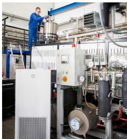
Abb. 2 Pyrolyse-Drehrohr im Technikumsmaßstab mit eigens entwickelter Kondensationsanlage im Vordergrund
