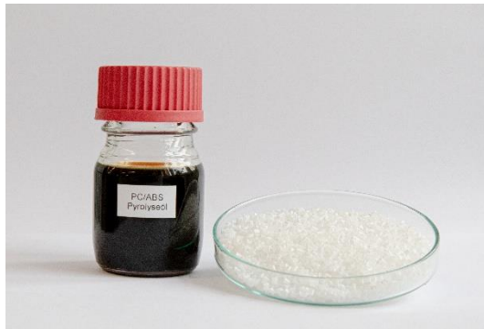
Abb. 3 Aus unterschiedlichen PC-haltigen Abfällen wird mit dem neuen Recycling-Verfahren Pyrolyseöl als Rohstoff für die Herstellung neuer Kunststoffe gewonnen.
