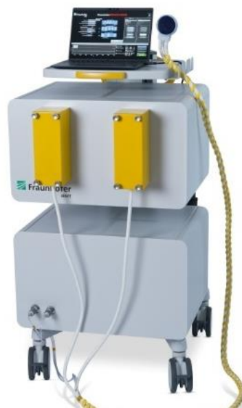
Abb. 3 Ultraschall-Therapiesystem für die Neurostimulation.
