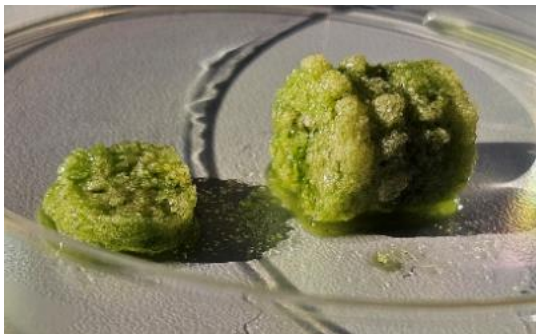
Abb. 2 Lebendes Baumaterial. Grün entsteht durch das Chlorophyll der lebenden Bakterien.
