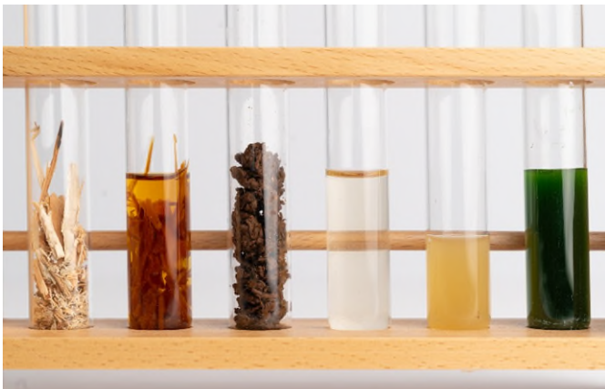
Abb. 2 Von links: Unbehandeltes Altholz, Holz in der Aufschlusslösung, Cellulosefasern (nach Kochung und Waschgang), Zuckerlösung aus Cellulosefasern, anaerober Wasserstoffproduzent (Bakterien), Mikroalgen
