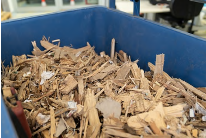
Abb. 1 Mit Holzschutzmitteln behandeltes Altholz muss derzeit in genehmigten Großkraftwerken verbrannt werden. In H 2 Wood entstehen daraus Wasserstoff, Carotinoide und Stärke.
