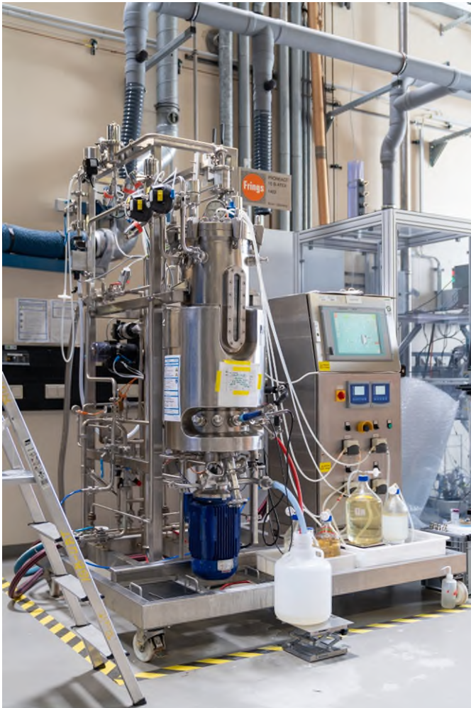
Abb. 3 Die Bakterien wachsen mit den aus dem Holz gewonnenen Zuckern und bilden dabei Wasserstoff und CO 2 .
