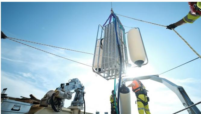
**Abb. 1** Mittels seismischer Messungen können die Wissenschaftlerinnen und Wissenschaftler Seekabel im Meeresboden hochgenau lokalisieren.
