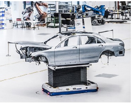
Montage ohne Band und Takt: Das Fraunhofer-Institut für Produktionstechnik und Automatisierung IPA gestaltet seine Matrixmontage produktiv und wandlungsfähig.
