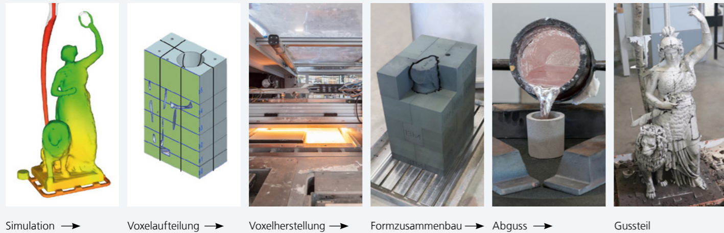
Simulation → Voxelauflösung → Voxelherstellung → Formzusammenbau → Abguss → Gussteil
